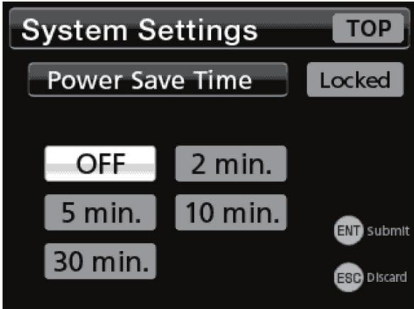
◀, ▶ 버튼으로 선택 위치를 이동시키고, ENT 버튼을 눌러 확정합니다. 선택 항목이 여러 줄일 경우는 선택 위치를 우측 끝까지 이동시키고 한번 더 ▶ 버튼을 누르면 다음 줄의 좌측으로 이동합니다.
