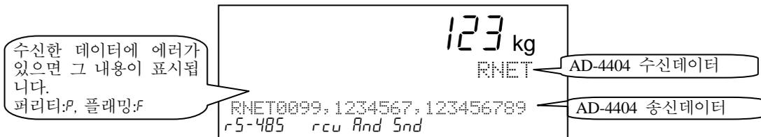
그림 71 표준 RS-485 입출력의 모니터 표시
