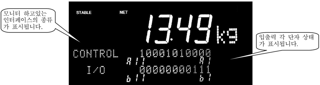
그림 69 모니터모드의 표시 예(컨트롤 I/O)
