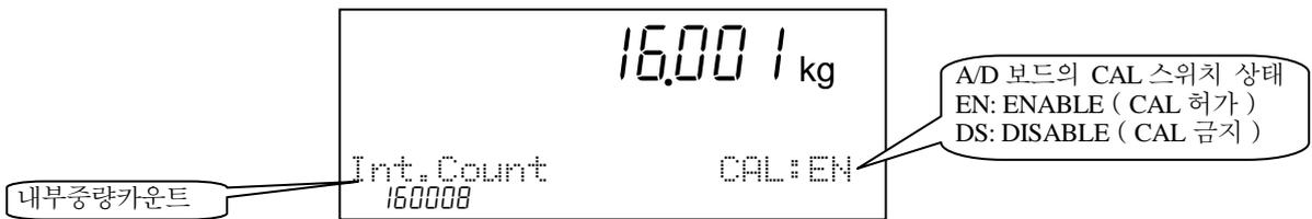
그림 73 A/D 컨버터의 모니터 표시
