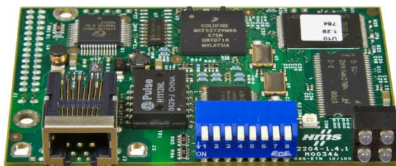
Figure 3-26 : Carte d'option EtherNet/IP
