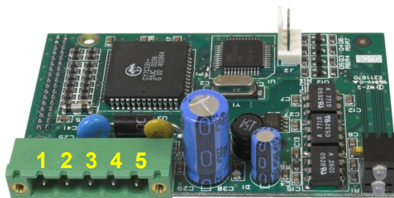
Figura 3-25: Placa de opção DeviceNet
