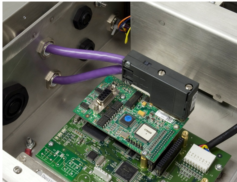
Abbildung 3-22: PROFIBUS-Anschluss im ACM500
