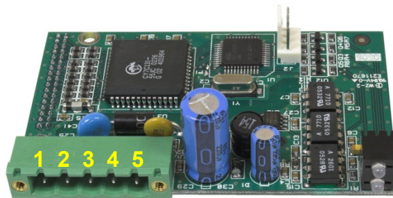
Figura 3-25: Tarjeta opcional DeviceNet
