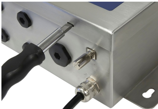
Figure 3-2 : Ouverture du boîtier
