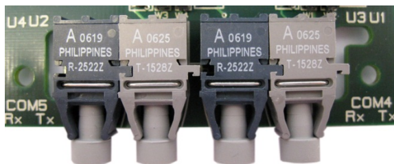
Figura 3-8: Connessioni cavo a fibra ottica a codice cromatico
