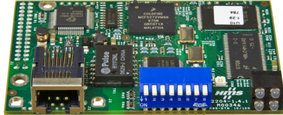
Figura 3-26: Placa de Opção de EtherNet/IP
