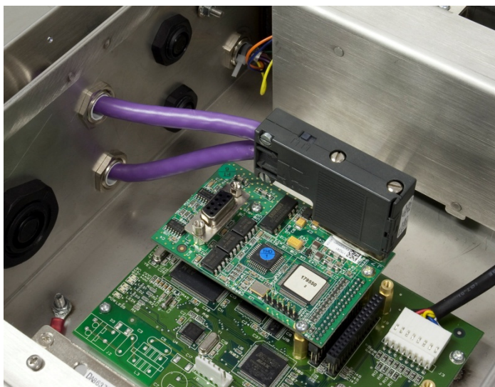
Figura 3-22: Connessione PROFIBUS in ACM500
