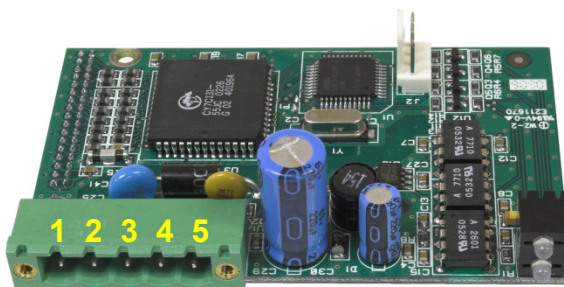
Figura 3-25: Scheda opzionale DeviceNet
