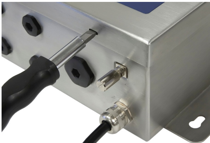
Figura 3-2: Como Abrir o Gabinete
