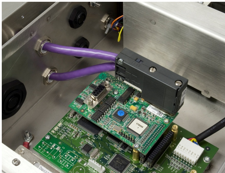
Figura 3-22: Conexão PROFIBUS no ACM500
