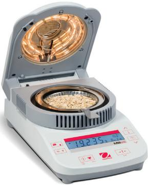
새로운 오하우스 MB23과 MB25 수분 분석기는 고 품질의 내구적인 구조와 쉬운 일단계 버튼 설정으로 구성되어 기술적인 모든 단계에서 작업자에게 이상적입니다. 큰 후광LCD 화면, 표준 RS232 포트, 0.1% 에서 0.05% 까지의 정밀도와 할로겐 또는 적외선 가열방식 선택으로, MB23과 MB25는 어떤 예산에서도 이용 가능합니다.
