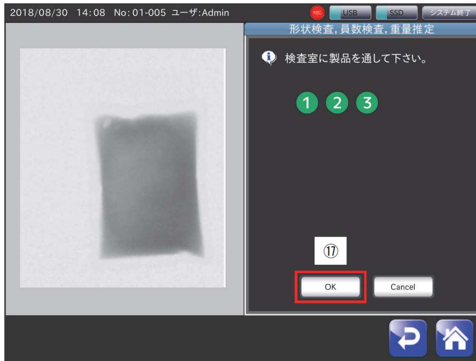
그림52 형상 검사/수량 검사/중량 추정 자동 설정 화면
