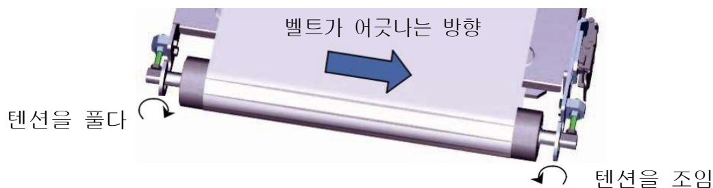
그림188 텐션 조정 예(벨트가 장치 정면 쪽으로 쏠릴 때)
