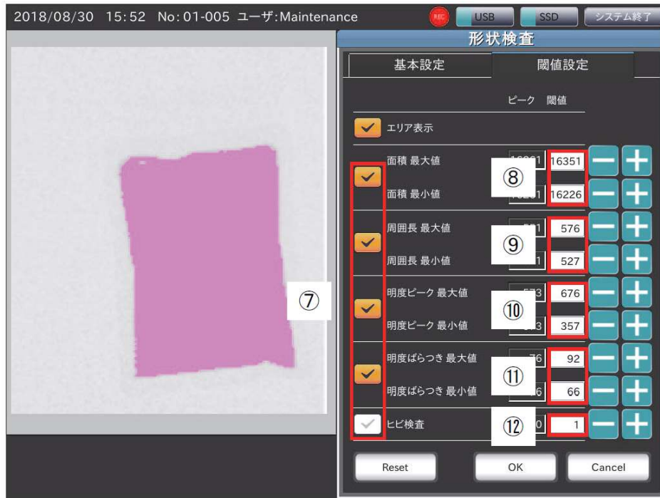
그림62 형상 검사 설정 화면(리미트값 설정 화면)
