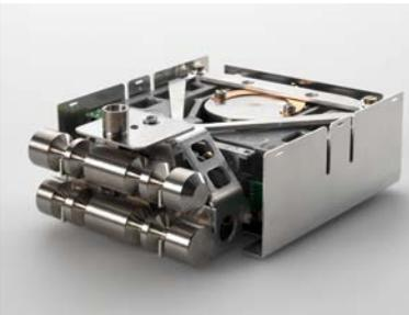
HRT 칭량 셀은 FACT 및 2개의 내부 테스트 분동과 함께 소수점 이하 5자리(0.01 mg)의 해독도를 제공하므로 매우 작은 샘플도 극도로 정확하게 칭량할 수 있습니다.
