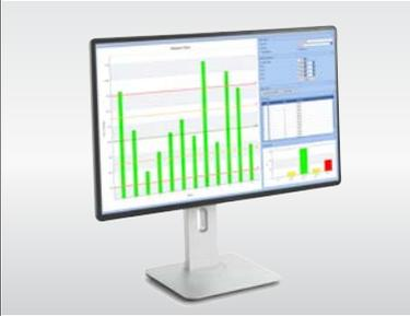
최대 10개의 저울에서 칭량 데이터를 자동으로 수집하고, 보고서를 작성하며, 통계 분석을 수행하고 저울 상태의 명확한 개요를 가집니다. 모든 칭량 데이터는 SQL 데이터베이스에 안전하게 저장되며, 다양한 형식 (XML, CSV, XLSX 또는 PDF)으로 칭량 데이터를 수동 또는 자동으로 내보낼 수 있습니다.
