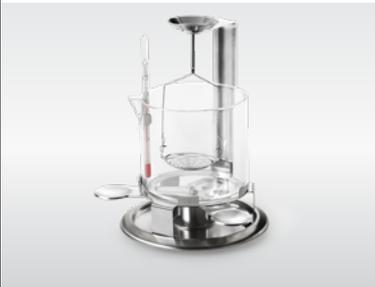
저울에 밀도 측정 키트를 설치하여 고체, 액체 및 다공성 샘플의 밀도를 측정할 수 있습니다. 내장형 Application이 프로세스 전반에 대해 안내합니다.
