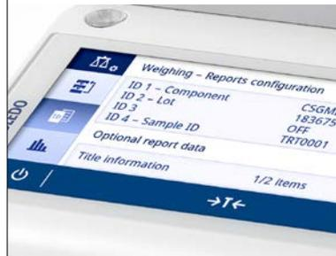
결과값과 관련 칭량 데이터를 저장, 인쇄 및 내보내는 방법을 원하는대로 설정합니다. PDF, CSV 및 XML 파일은 USB 메모리 스틱은 물론 FTP 서버에도 저장할 수 있습니다.
