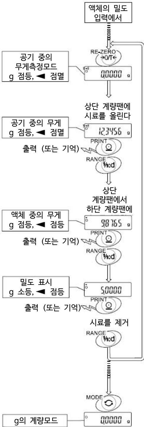
2. 상단 계량팬에 시료를 올리고, 표시가 안정되기를 기다립니다. 시료의 중량을 출력 (또는 기억)한 경우 [PRINT] 키를 누릅니다. 다음에 [RANGE] 키를 눌러 공기중의 무게를 확인하고 액체의 무게 측정 모드 (g 점등,  $\blacktriangleleft$  점등)로 이동합니다.
